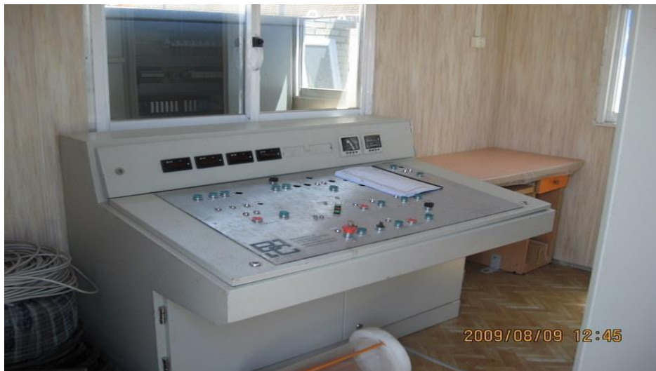
شکل ۴: سیستم کنترل بچینگ
