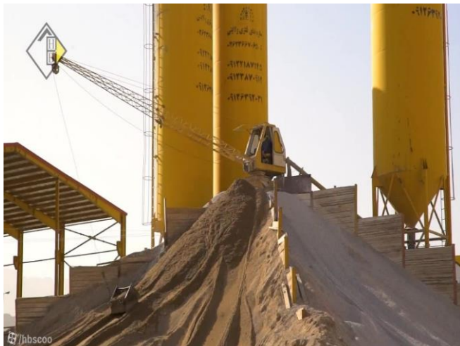
شکل ۲: دیو‌ی سنگدانه و نحوه‌ی برداشت آن با باکت
