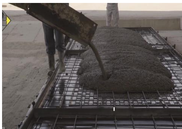
شکل ۲: بتن‌ریزی و پرداخت سطح قطعات پس از بتن‌ریزی
