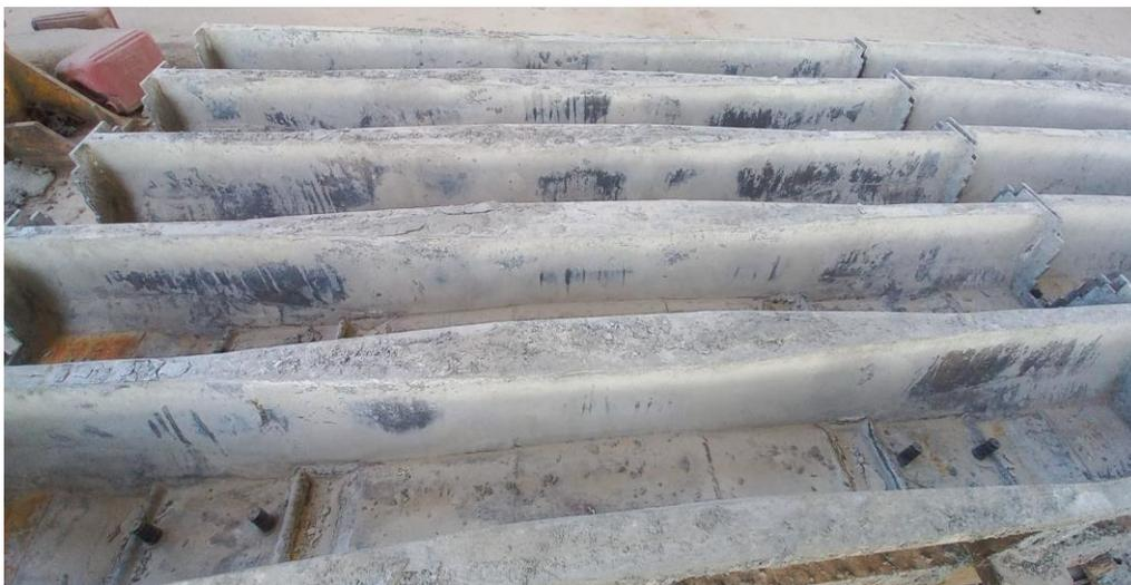
شکل ۴: رسوبات تشکیل‌شده بر روی قالب‌های تراورس بتنی
