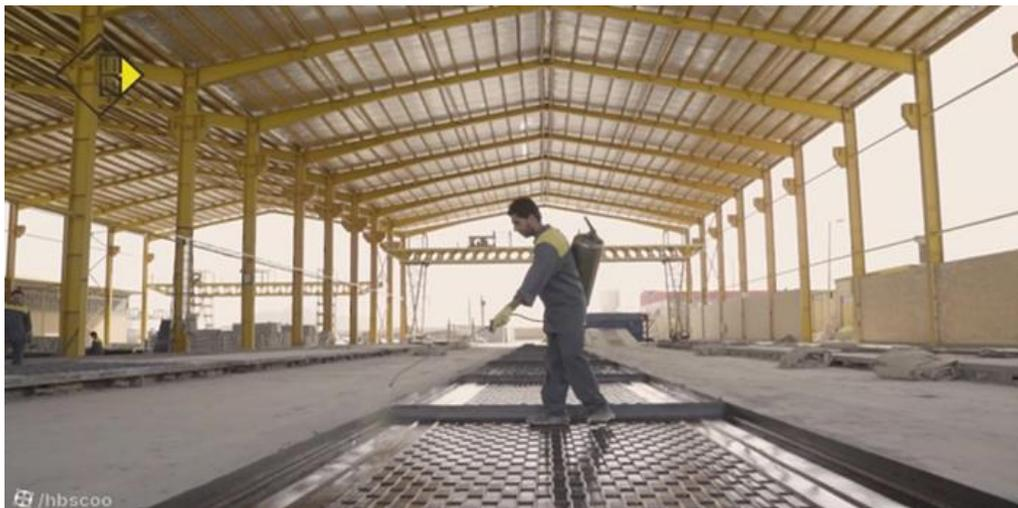
شکل ۱: قالب‌های مورد استفاده در واحد تولید و آماده‌سازی آن‌ها با پاشش گازوئیل یا روغن قالب
